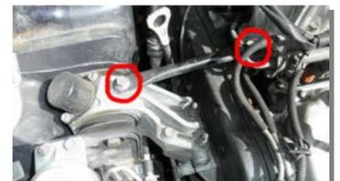
8. Zuerst bauen wir den Ölmesstab ab. Dieser ist mit 1 Schraube an dem Motor Befestigt (Bild rot markiert). Ist diese Schraube ab kann der Stab samt Röhrchen, mit leichten drehenden Bewegungen, nach oben abgezogen werden. Um später Dreck im ÖL zu vermeiden empfehle ich ein Stück Lappen in das Loch in der Ölwanne zu stecken wo vorher der Stab saß.
