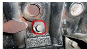
**23.** Um aber die Wasserpumpe abzuschrauben müssen wir zuerst den 2ten teil der Motorhalterung abschrauben. Um diesen zu entfernen ist es zwingend nötig dass die Servopumpe abgeschraubt wird. Dafür gibt es 2 Möglichkeiten.
