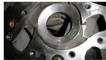
**24.** Kommen wir jetzt zur neuen Wasserpumpe. Diese legen wir vor uns. Nun verteilen wir einen Streifen Dichtungsmasse wie auf dem Bild. Jetzt legen wir noch die beigelegte Dichtungsmatte auf die dünne Schicht. Auf die Dichtungsmatte tragen wir nun auch noch ein bisschen von der Dichtungsmasse auf.
