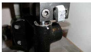
darauf achten das ihr dies wirklich langsam macht da in dem Gerät ein enormer Druck herrscht. Also immer so 1-2 Umdrehungen mit dem Schraubstock und dann 2-3 Sekunden warten damit der Druck sich "verteilt hat". Dieses wiederholen wir solange bis das Loch in dem Stift und das Loch im Gehäuse übereinstimmen. Liegen diese Löcher übereinander stecken wir einen LANGEN Nagel hindurch um den Stift zu arretieren.
