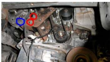
**15.** Ist das geschafft muss jetzt der OT (oberer Totpunkt im Zylinder 1) eingestellt werden. Dafür drehen wir die Schraube der Riemenscheibe wider auf die Kurbelwelle. Mit der ½ Zoll Knarre und einer 22er Nuss drehen wir die Kurbelwelle IM UHRZEIGERSINN (wenn ihr drauf seht) bis alle 3 Markierungen an der Nockenwelle und der Kurbelwelle auf die OT Markierungen zeigen (Bild)
