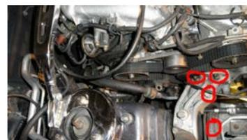
**18.** Um den Zahnriemen demontieren zu können muss zuerst der Zahnriemenspanner gelöst werden. Hier kommt das Spezialwerkzeug zum Einsatz. Dieses hat eine 1/4 Zoll große Öffnung in der Mitte für eine kleine Knarre. Damit halten wir die Spanrolle fest und lösen mit der anderen Hand die Spanrolle. Ist diese gelöst, schrauben wir diese auch gleich ab da im Zahnriemensatz eine neue enthalten ist.
